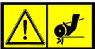
Bei laufendem Motor unter keinen Umständen mit der Hand oder anderen Körperteilen unter den Rand oder unter das Fräsgehäuse kommen.
