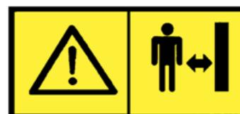
Vorsicht: Im Betrieb können Fremdkörper aus dem Mähergehäuse heraus geschleudert werden. Dritte während des Mähbetriebes fernhalten.
