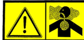
Vergiftungsgefahr. Das Abgassystem des Gerätes setzt giftige Gase frei. Den Motor niemals in geschlossenen Räumen starten.
